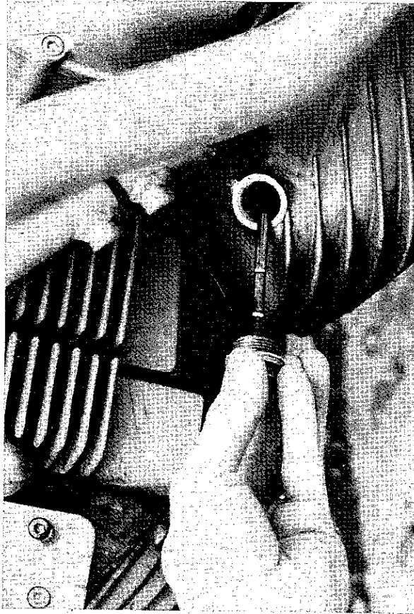
Jauge à huile avec ses deux repères mini et maxi. (Photo RMT).
